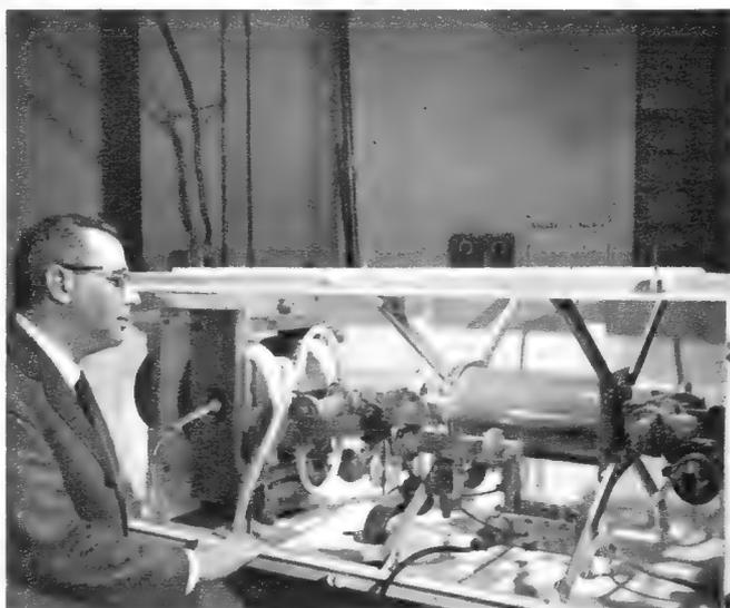
Bild 2. Die 10-kW-Sender-Endstufe während der Laboratoriumstests. In Fucino ist dieser Teil an der Rückseite der Antenne montiert, wie in Bild 1 zu erkennen ist
