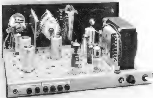
Bild 5. Innenaufbau des Röhrenvoltmeters
